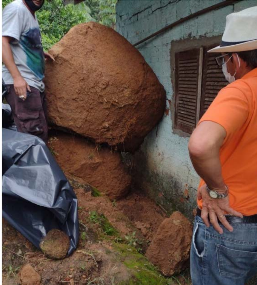
Figura 17. Matacão granítico rolado em evento de chuva volumosa que deflagrou movimentos gravitacionais de massa no bairro Prado em março de 2021
