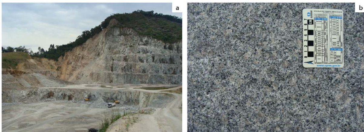
Figura 9. Lavra de granito para produção (a); detalhe do granito fácies Granito São Pedro de Alcântara (b)
