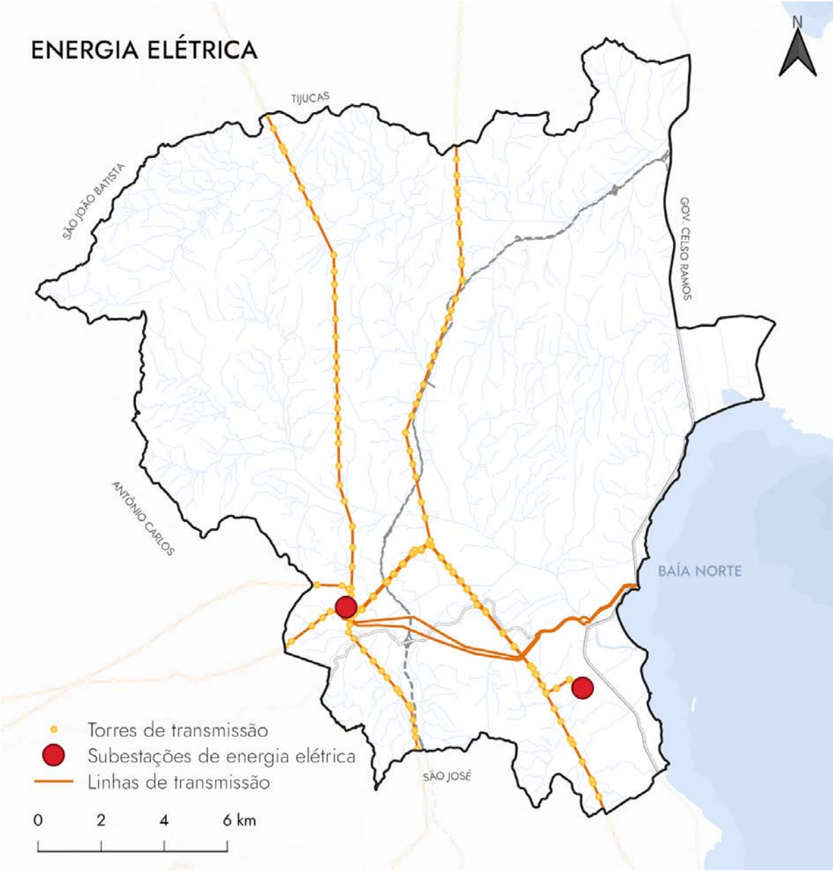
Figura 418. Principais infraestruturas de energia elétrica em Biguaçu
